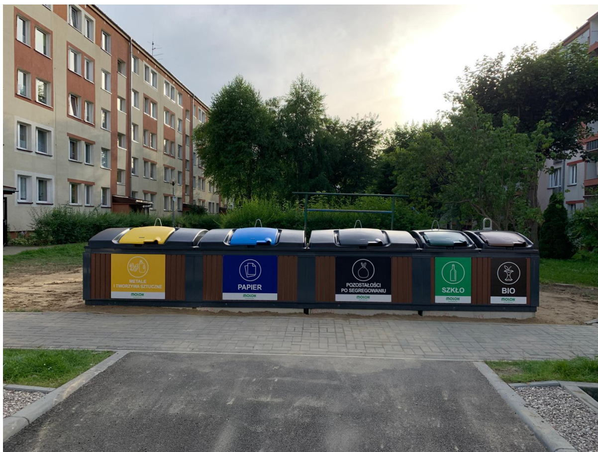
Rysunek 3. Przykładowe rozwiązanie zastosowania pojemników półpodziemnych Molok [16-19]
